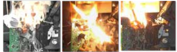
図1 電気装置燃焼実験（基板通電後トラッキング発生→基板に着火→延焼拡大）
