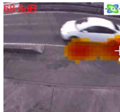
図8 マイクロホンアレイによる音源分離結果の例
