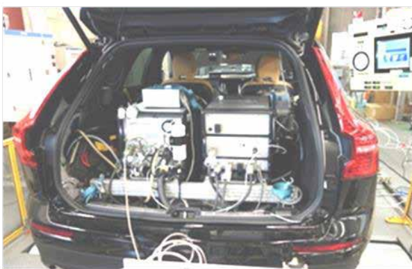
図3 車載式排出ガス測定システム（PEMS）
