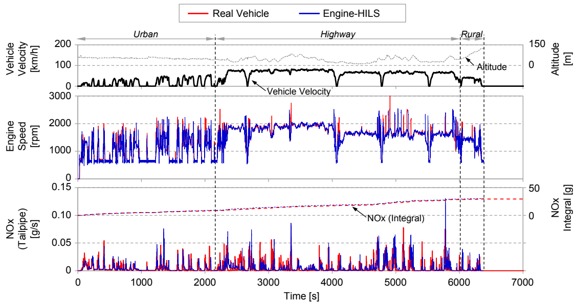
図8 RDE試験時のエンジン回転数及びNOx排出量の時間履歴：ルート2（実車及びエンジンHILS）
