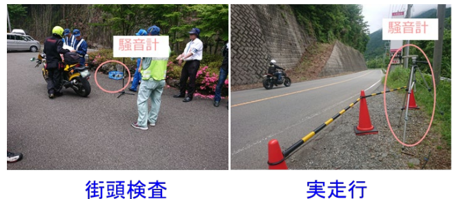
図2 街頭検査における近接排気騒音試験の様子と実走行の様子
