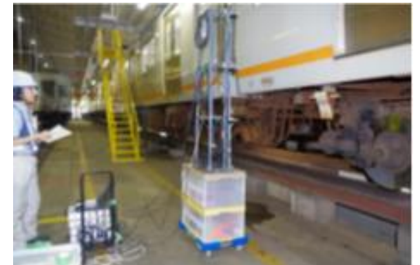
鉄道車両の外側に発生する磁界の測定
