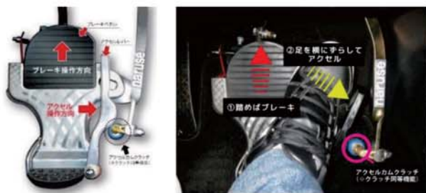
図1 機械式装置の概念図と操作方法 (ワンペダルホームページ資料より)
