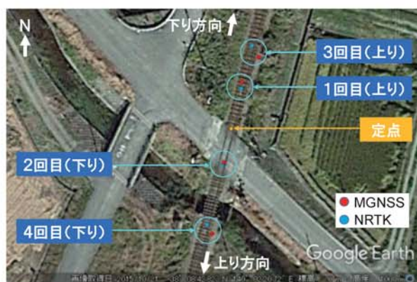
図6 踏切Aにおける衛星測位結果のプロット
