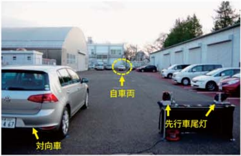
図3 対向車側から見た実験装置の様子
