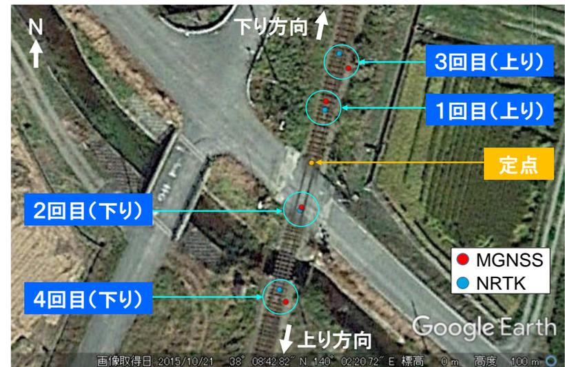
地上側定点に対する車上の衛星測位結果
