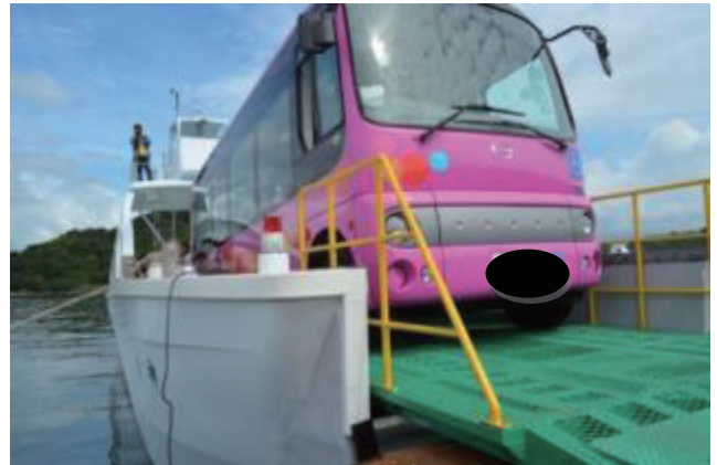
図3 棧橋におけるバスの乗下船試験
