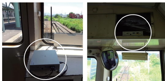
図2 バッテリー方式(左)、車両給電方式(右)
