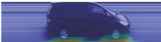
図 3 騒音源可視化結果：乗用車、50km/h
