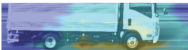
図 4 騒音源可視化結果：トラック、50km/h
