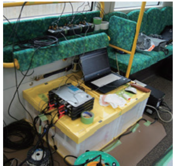
図5 試験線での電力量の測定例
