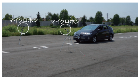
図 9 テストコースにおける接近音の試験法の検証
