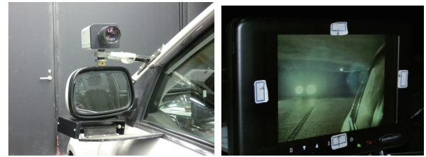
図 9 サイドミラー代替用 CMS カメラ設置位置 図 10 サイドミラー代替用 CMS モニタ画像
