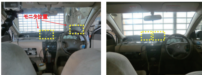
(a)左右分散型配置 (b)中央集中型配置 図 7 CMS 試験システムのモニタ設置位置 (モニタ 2 台)
