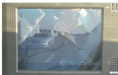
図 13 昼光によるモニタ上の後続車両視認性低下
