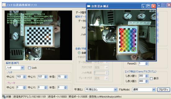
図 8 台形歪み補正処理状況 (力行ノッチ)
