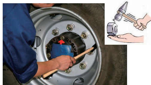
図8 点検ハンマによる点検
